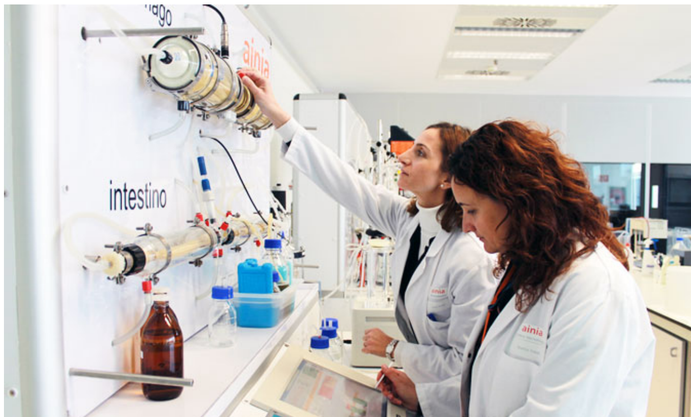
Digestor dinámico in vitro (aparato digestivo artificial) de Ainia, donde se realizan estudios de biodisponibilidad. ©Ainia
